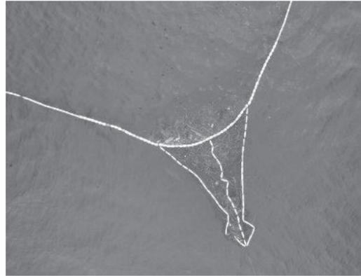
Fig. 4 クリーンオーシャンアンサンブルで開発している海洋ごみ回収装置。これまで第 5 号機まで回収装置を開発・改良してきた。写真は、第 6 号機。三角形の部分が回収ポケットで、そこから左右に垣網が広がるような構造をしている。回収ポケットには、茶色の葦などの天然の漂流ごみに加えて、白色の漂流プラスチックごみ(主に、ペットボトル)が捕らえられている様子が見える。
